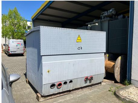
Gebrauchte TST des Herstellers Betonbau, Baukörper Typ: T95, ausgerüstet mit gasisolierter Schaltanlage von F&G, Typ: GA2K1TSC (Ring/Ring/Trafoabgang mit Sicherungslasttrennschalter).
